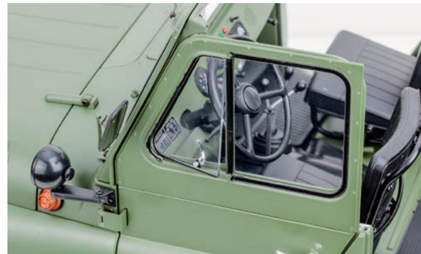
Шаг 4. Проверьте возможность открывания поворотного стекла двери. Для этого поверните ручку на рамке стекла двери вверх (фиксатор освободит рамку стекла), а заднюю часть стекла — в сторону от водителя.
