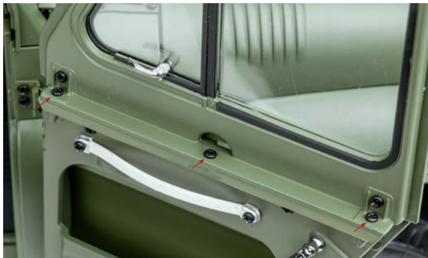
Шаг 3. Установите собранную надставку поверх передней правой двери модели. Совместите центровочные элементы деталей и закрепите надставку при помощи трех винтов 1,7x4 (AP).
